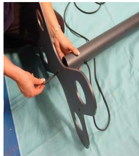
3. Unire le due parti che compongono il basamento quadrilobato (D) e avvitare al palo più corto (A), dentro cui scorre il cavo di alimentazione, utilizzando le viti 8x25 a testa svasata a brugola serrandole con la brugola 5 in dotazione.
