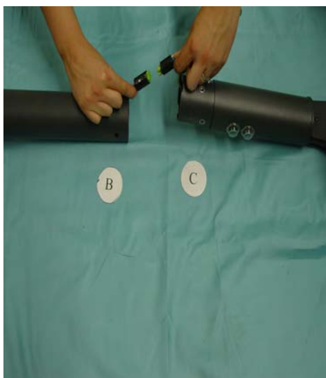
6. Connettere la parte alta del Fungo con i due riscaldatori. Collegare i 2 connettori, far rientrare il cavo connesso nel tubo e infilare i due pali B e C uno nell'altro. Avvitare le 4 viti a brugola da 6MA puntandole prima e poi serrandole. A questo punto l'apparecchio è pronto per essere utilizzato.
